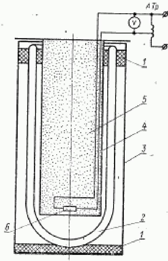
1—фторопластовая или резиновая прокладка; 2—сосуд Дьюара; 3—корпус; 4—медный стакан; 5—измельченная двуокись углерода; 6—нагреватель; АТр—лабораторный автотрансформатор; V—вольтметр
