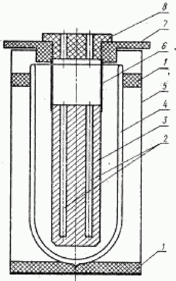
1—резиновая или пенопластовая прокладка; 2—гнезда; 3—медный блок; 4—сосуд Дьюара; 5—корпус; 6—подвеска из нержавеющей стали; 7—текстолитовый фланец; 8—текстолитовая крышка
