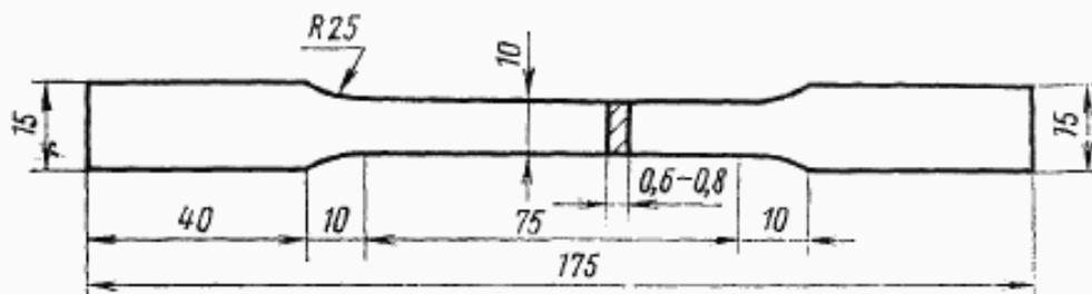
5.7. Для проверки механических свойств при растяжении от каждого контролируемого листа от любого конца вырезают одну заготовку.
