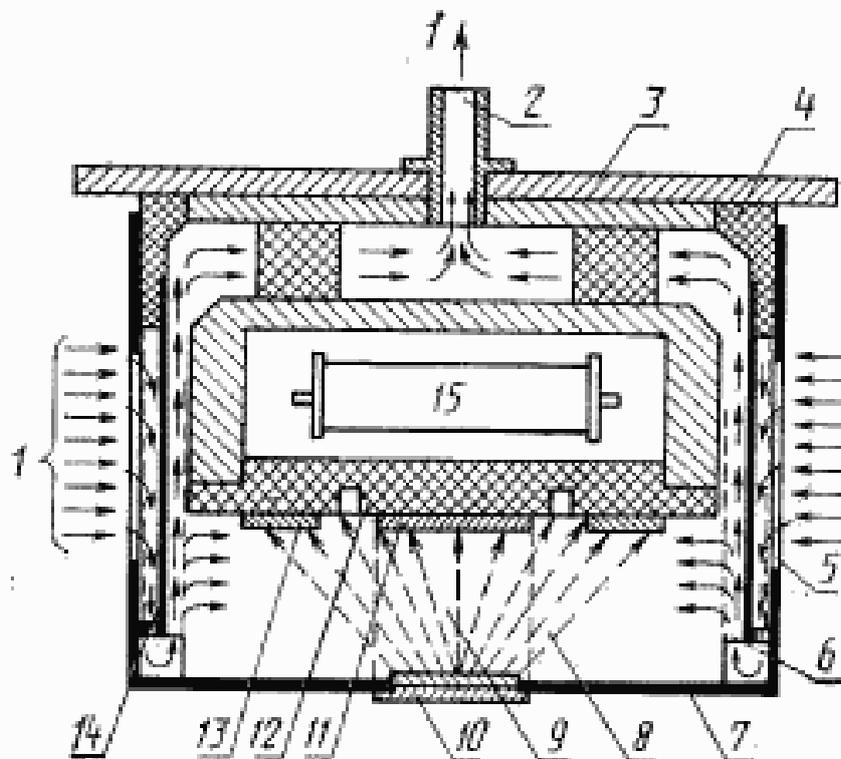
1 — контролируемая среда; 2 — штуцер всасывания контролируемой среды; 3 — основание конструкции; 4 — изолирующее кольцо; 5 — внешняя сетка; 6 — внутренняя сетка; 7 — внешний электрод; 8 — излучение; 9 — измерительный объем; 10 — источник ионизирующего излучения; 11 — измерительный электрод; 12 — изоляционный материал; 13 — обранное кольцо; 14 — ветрозащита; 15 — измерительный резистор; стрелками показано направление движения контролируемой среды при пробоотборе
