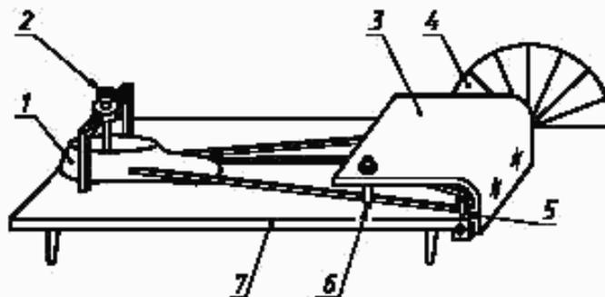
1 — ласта; 2 — прижимной винт; 3 — изгибающая пластина;
