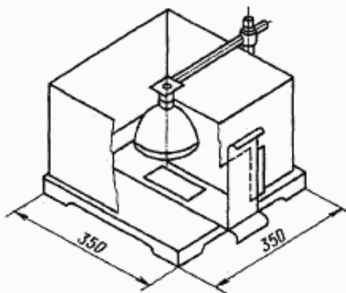
Установка для определения летучих веществ состоит из инфракрасной лампы, укрепленной на штативе над столом и огороженной экраном из белой жести.
