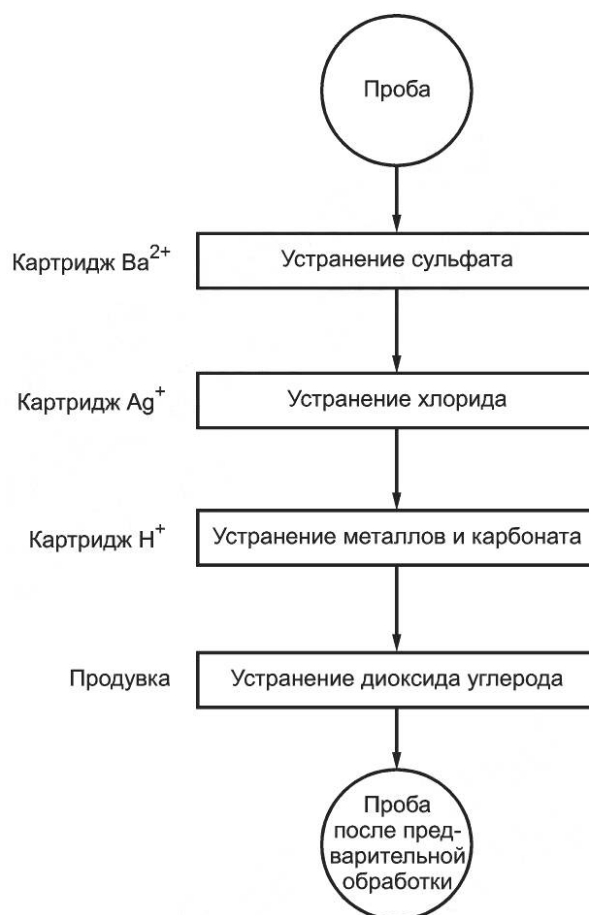
Рисунок С.1 — Этапы предварительной обработки проб
