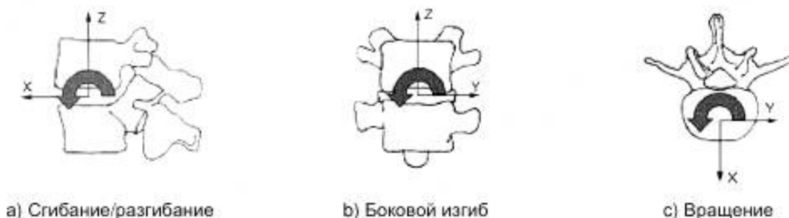
Рисунок 1 — Определения угловых смещений и оси координат
