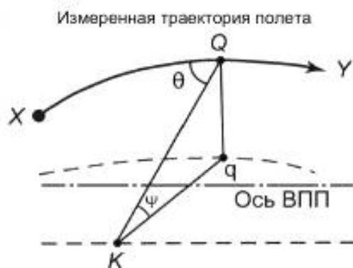
Рисунок 4 — Участки измеренной и исходной траекторий полета на оси ВПП
