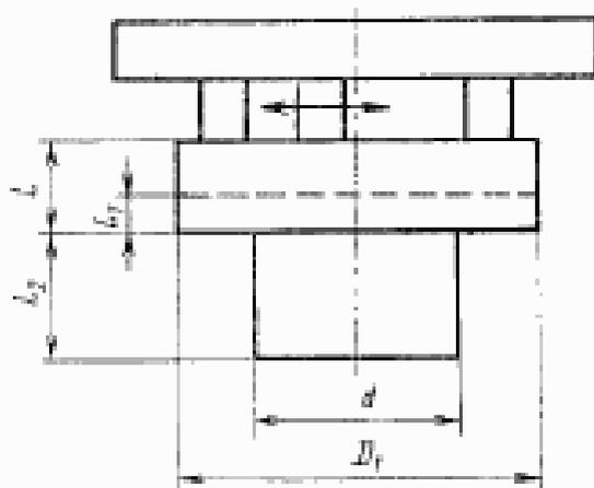
$D_1 \approx \frac{1}{2} D_{\max}$ , но не более 300 мм, где  $D_{\max}$  наибольший диаметр обрабатываемого изделия над станком,  $d = 0,75 D$ .
