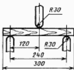
4.2. Образец нагружают равномерно с постоянной скоростью нагружения или постоянной скоростью перемещения активного захвата машины. Скорость должна быть такой, чтобы образец разрушился через  $(1,5 \pm 0,5)$  мин после начала нагружения.
