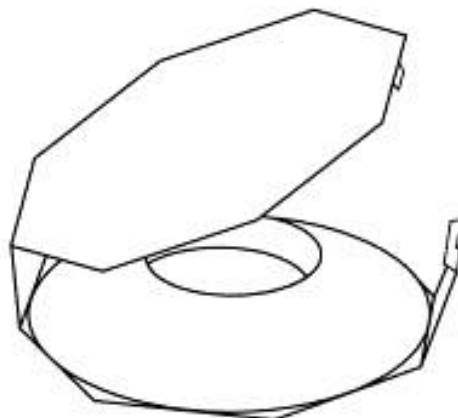
Рисунок С.6 — Картонная крышка с цельными пластиковыми ловушками-западняй и пропитывающая подушка для масла-приманки
