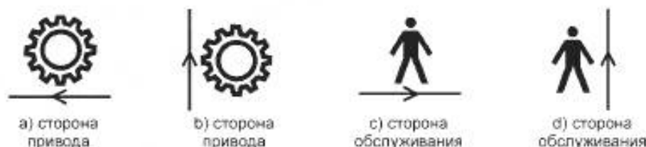
Рисунок A.10 — Примеры рисунков для обозначения стороны привода и стороны обслуживания
