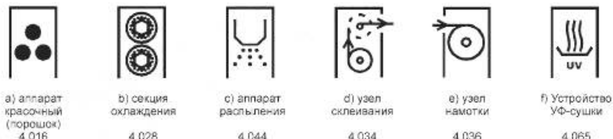
Рисунок A.7 — Примеры комбинирования базовых символов для обозначения секций и модулей, являющихся составной частью оборудования
