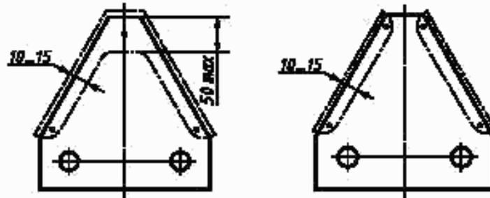
**ЗОНЫ ЗАКАЛКИ ПРОТИВОРЕЖУЩИХ ПЛАСТИН**
