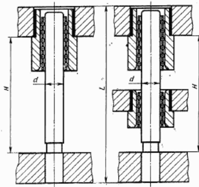
Величина раскрытия  $H$  шарикового направляющего узла 2-го исполнения равна величине раскрытия соответствующего шарикового направляющего узла 1-го исполнения. Например, в направляющий узел исполнения 2 1030-7001 входит направляющий узел исполнения 1 1030-6201. Поэтому в соответствии с таблицей величина раскрытия узла 1030-7001 составляет  $H_{\text{норм.}} = 60$  мм,  $H_{\text{макс.}} = 95$  мм.
