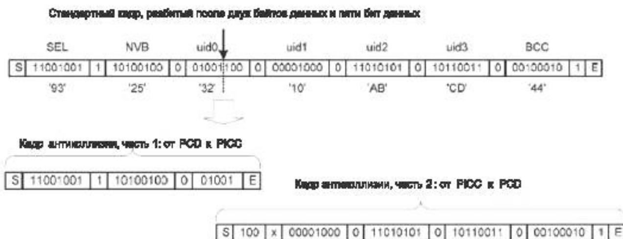
Рисунок 6 – Организация бит и передача бит-ориентированного кадра антиколлизии, случай SPLIT BYTE
