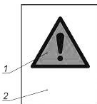
1 — знак W001 «Общее предупреждение» согласно ISO 7010; 2 — дополнительный текст для чтения «Опасность опрокидывания или заливания»
