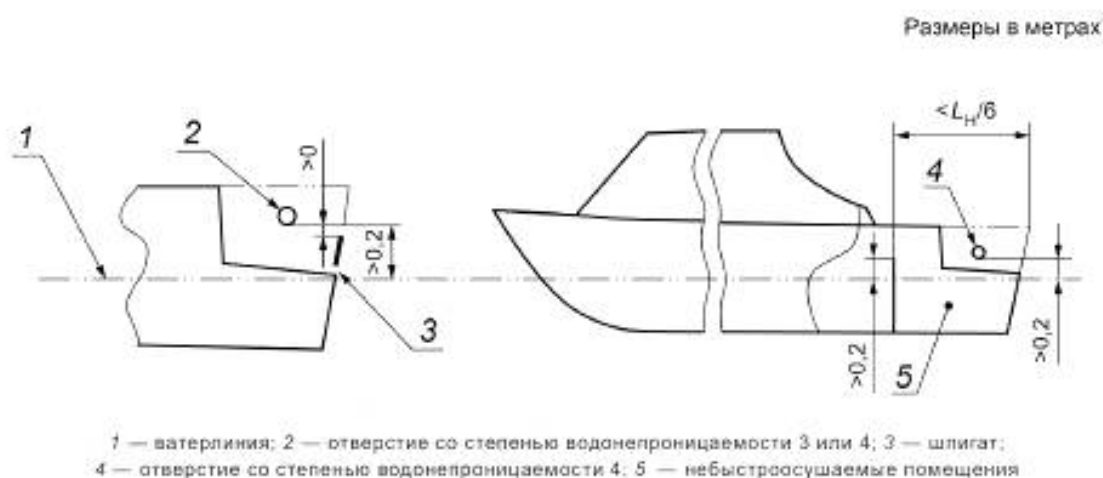
Рисунок 2 — Отверстия в нише подвесного мотора
