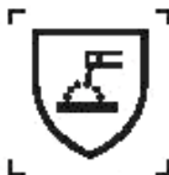
Рисунок 1 — Пиктограмма защиты от рисков при сварочных работах (ИСО 7000-2683)
