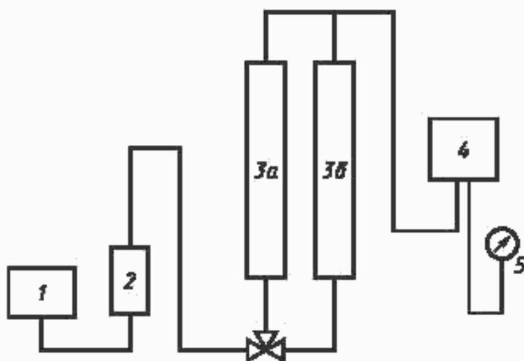
1 — источник сжатого воздуха с системой, обеспечивающей стационарный поток газа через манометр, 2 — сосуд — осушитель сжатого воздуха, 3 (а, б) — расходомеры (газомеры) или система расходомеров, 4 — держатель образцов, 5 — жидкостный манометр
