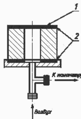
1 — промасленная калка или вакуумная резина; 2 — замазка
