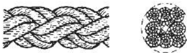
Рисунок 4 — Конфигурация 12-рядного плетеного каната (тип Т)
