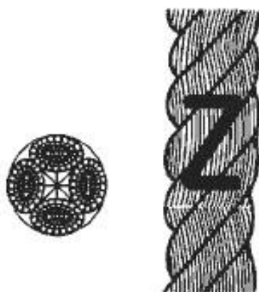
Рисунок 2 — Конфигурация 4-рядного крученого каната (тип В)
