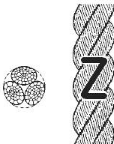
Рисунок 1 — Конфигурация 3-рядного крученого каната (тип А)
