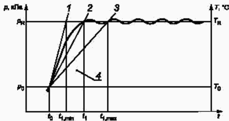
1 — максимальная скорость подъема давления на стадии подачи пара  $(p_R - p_0) / (t_{1, \min} - t_0)$ ;
