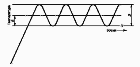
A- зарегистрированная температура; B- максимальное допустимое отклонение; C- минимальная регдаментированная температура; D- область температуры стерилизации
