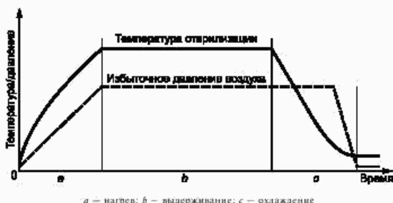
Рисунок В.3 — Пример цикла стерилизации паровоздушной смесью
