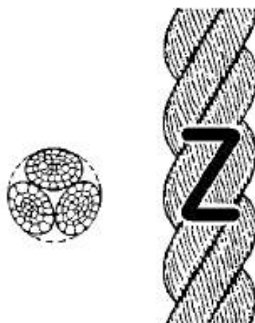
Рисунок 1 – Конфигурация 3-рядного (hawser-laid) каната (тип A)
