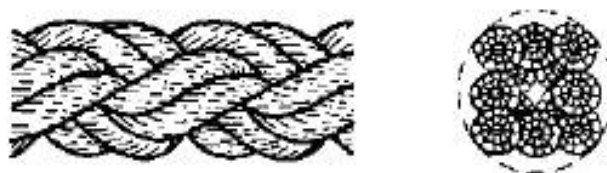
Рисунок 2 – Конфигурация 8-рядного плетеного каната (тип L)
