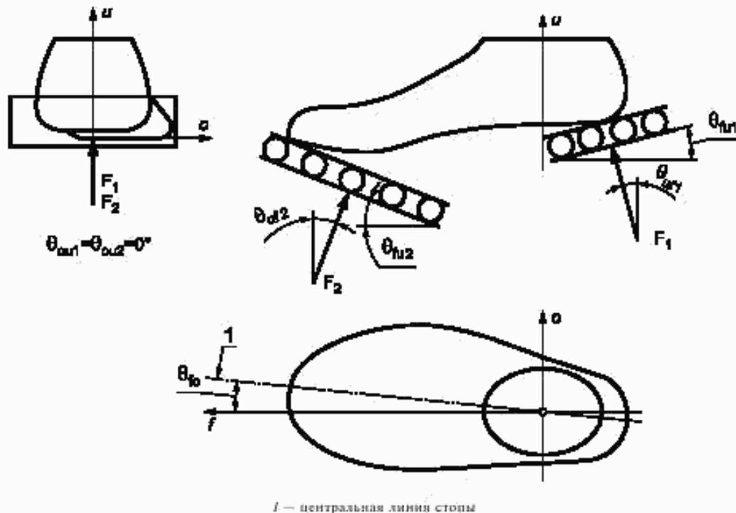
Рисунок 1 — Положение образца в испытательном оборудовании
