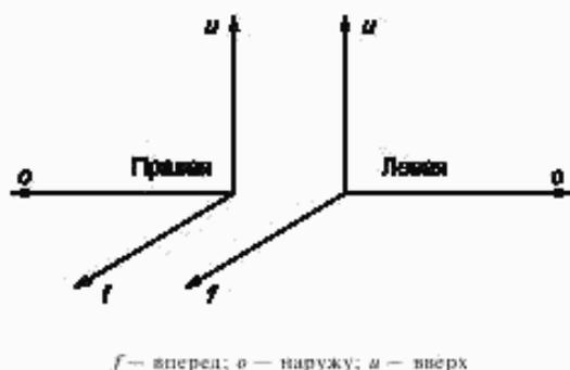
Рисунок 1 — Системы координат для право- и левостороннего применения образца
