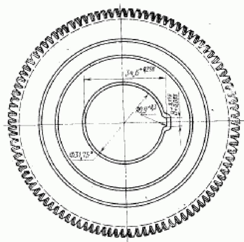
\* Допускается выполнять диаметр отверстия 31,743 мм.
