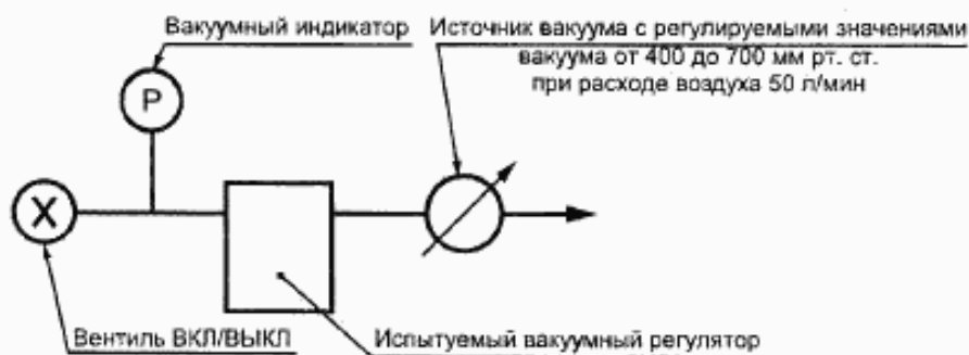
Рисунок А.9 — Испытание вакуумного регулятора с заданным вакуумом
