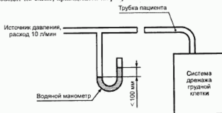
Рисунок А.6 — Испытание устройства для дренажа грудной клетки положительным давлением
