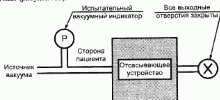
Рисунок А.5 — Схема измерения максимального допускаемого вакуума
